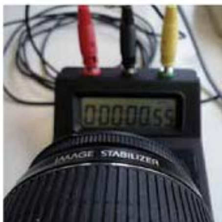
Test zpoždění závěrky: testující drží senzor, který v okamžiku stisknutí spouště aktivuje stopky. Fotoaparát je při zkoušce v plně automatickém režimu.
